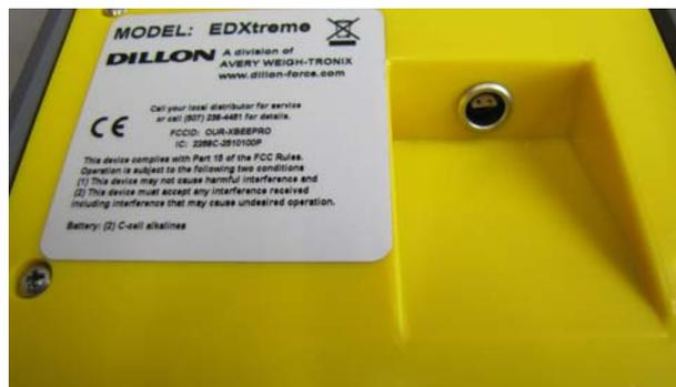
**Figure 2.2 EDXtreme Connector (CELL)**
